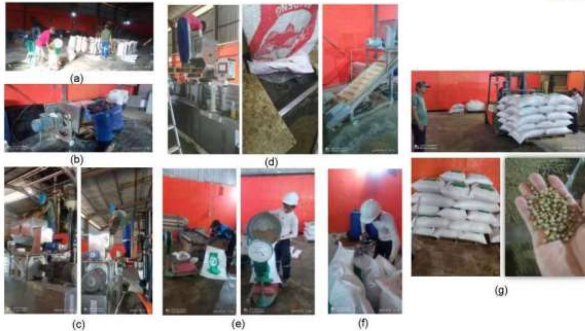
Gambar 22. (a) Proses Penimbangan Formulasi Pakan; (b) Proses Pencampuran Formulasi Pakan ( Mixing ); (c) Proses Pemasukan Formulasi Pasca Mixing (tahap Feeding ); (d) Proses Pencetakan Pakan (Mesin Extruder); (e) Proses Penimbangan Pakan Buatan; (f) Proses Pengemasan Pakan ( Packing ); dan (g) Pakan yang Diproduksi
